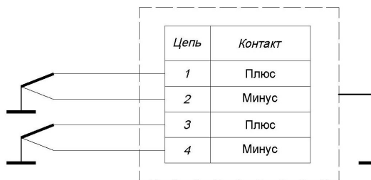
Рисунок Д.4д – Схема соединений для ПТ с неизолированными рабочими саями (индекс «Н» в позиции «Тип сая» в записи при заказе) с двумя термopами
